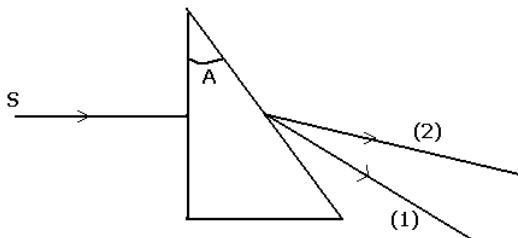
$$\text{نعطي : } \lambda_V = 0,4\mu m \quad \lambda_R = 0,6\mu m \\ \text{معامل الانكسار : } A=30^\circ \quad n_R = 1,65 \quad n_V = 1,673$$
